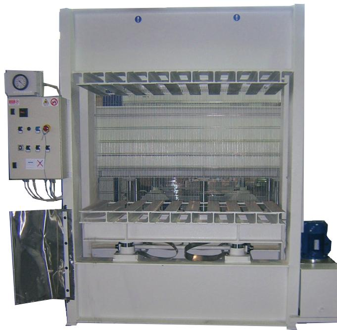
Pressa per curvare in travi di grosso spessore assemblate e fresate. Piani in travi piallate a vista per il facile aggancio degli stampi - pannello di controllo completo di tutti gli accessori per il funzionamento della pressa
